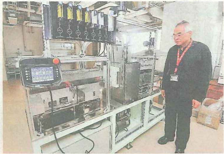
FRPを自動で分解処理する装置の試作品と水口特任教授（上田市の信大繊維学部）
